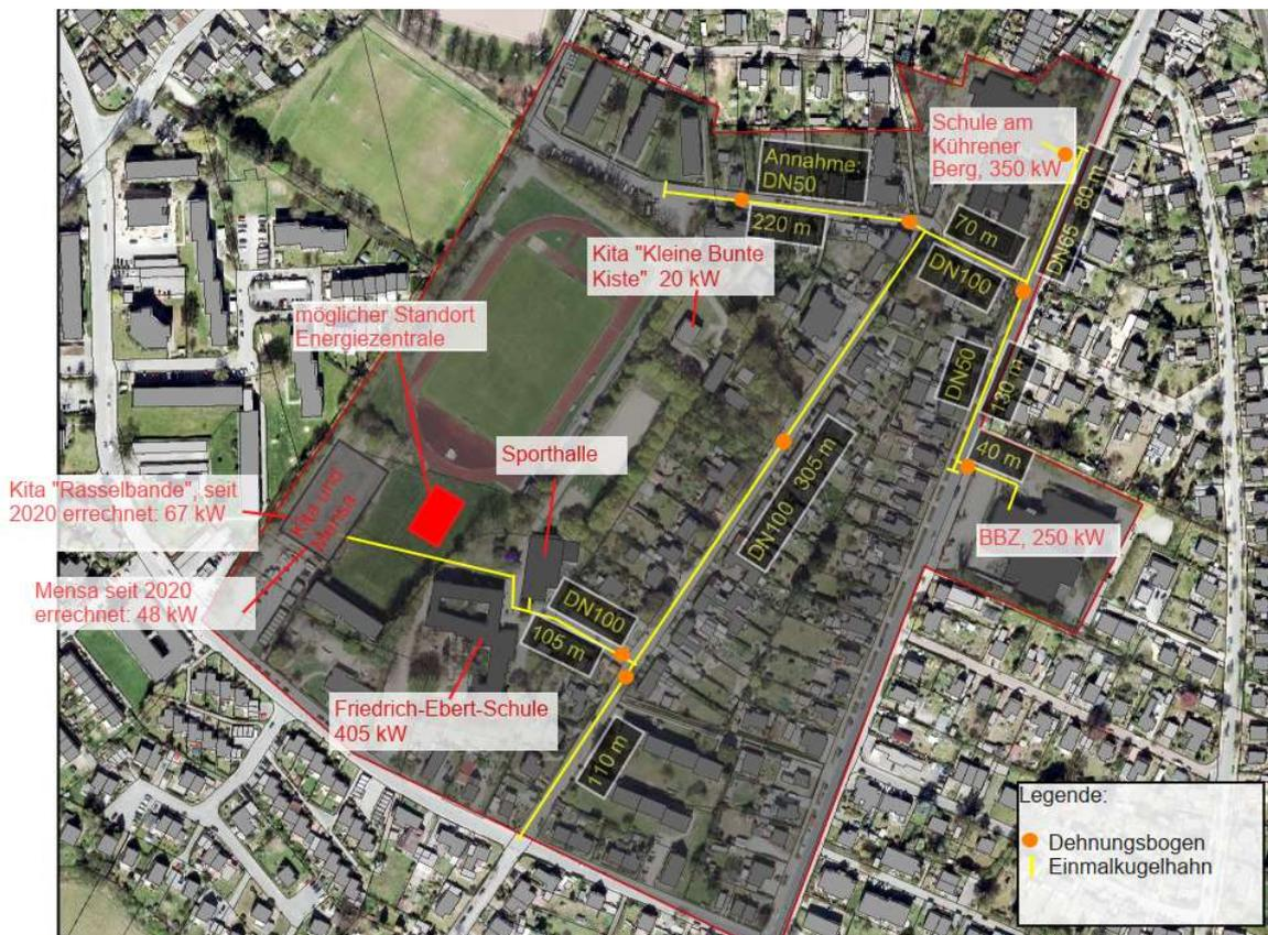
Abbildung 3-2: Übersicht Nahwärmenetz
